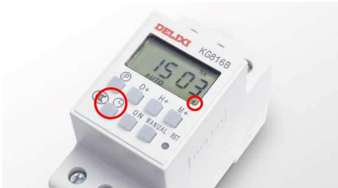
2. 按“P”键会进入定时设置。屏幕最左侧显示竖排“ON”和“1”，表示第一组定时的电路接通的时间。此时，按下“H+”调整小时；按下“M+”调整分钟；按下“D+”调整显示在最上方的星期。按需求调整好所需接通电路的时间。
