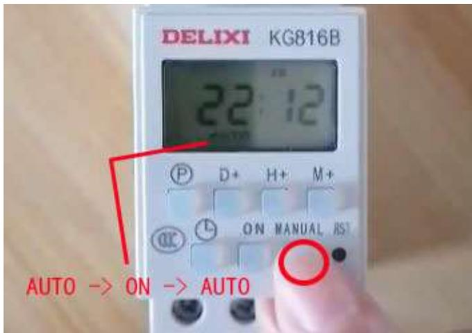
7.2 若当前实际时间是 2 3 点，此时电路应该处于断开状态。此时按下两次“取消键 / 手动”按键，确保屏幕最下方的文字从没按前的“A U T O”到“O F F”再回到“A U T O”。至此，设置完成。
