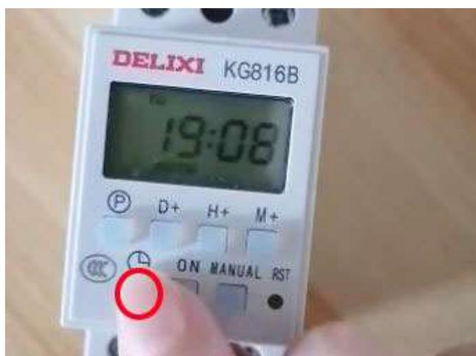
6. 确认此时显示的“标准时间”是否准确。此界面按下“H + ”调整小时；按下“M + ”调整分钟；按下“D + ”调整显示在最上方的星期。按照实际标准时间调整。
