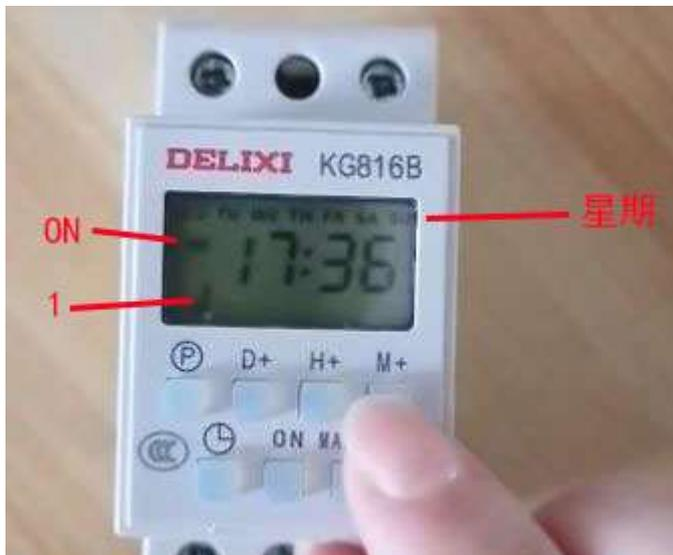
3. 再次按“P”键。屏幕最左侧显示竖排“OFF”和“1”，表示第一组定时的电路断开时间。此时，按下“H+”调整小时；按下“M+”调整分钟；按下“D+”调整显示在最上方的星期。按需求调整好所需断开电路的时间。
